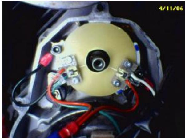
Mise en place du stator
