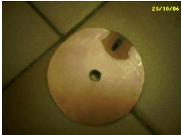
Rotor fini vu côté cuivre
