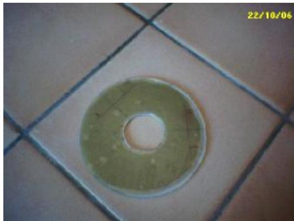
Tracé des trous de fixation sur le plateau.
